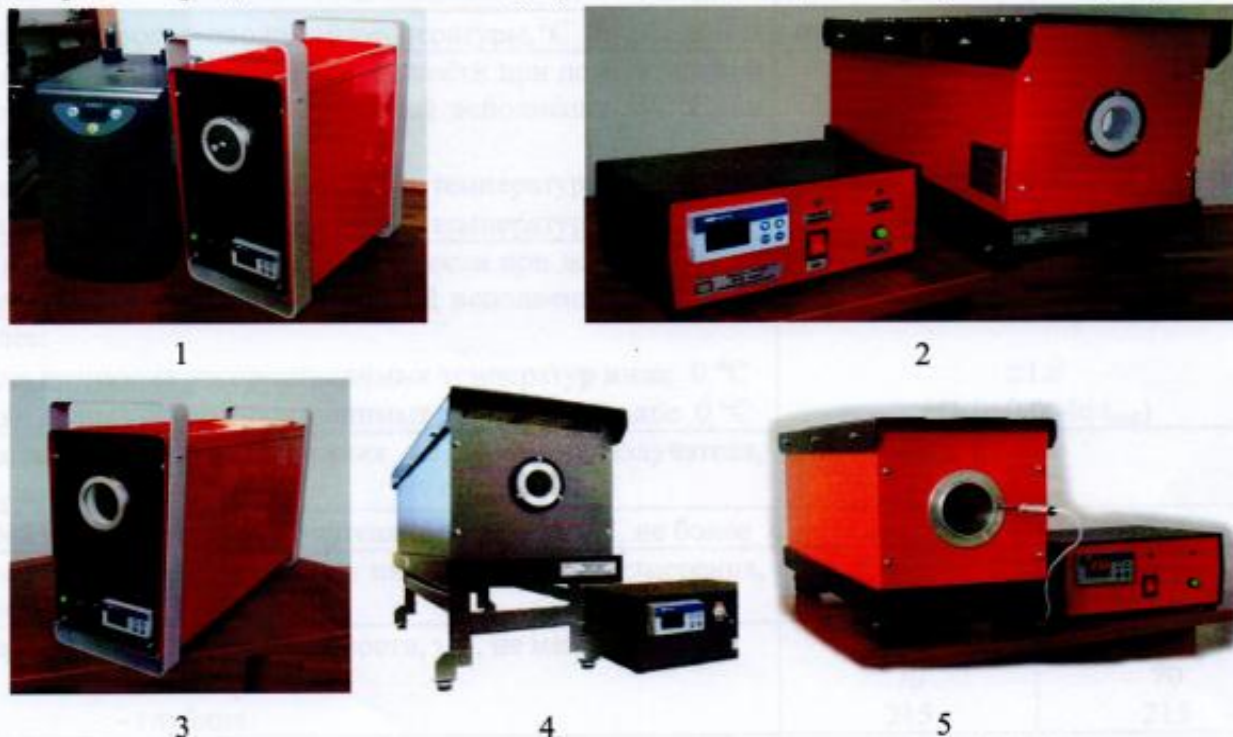
Рисунок 1 – Общий вид излучателей АЧТ 50/1500
